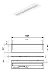
Scheda tecnica Philips Pannello A LED CoreLine RC136B 22/31W 2800-4000lm - 830 Luce Calda - | 120x30cm - UGR <19 - Dali Dimmerabile - Potenza Selezionabile
