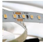
**Scheda tecnica Noxion Strisce LED SMD 120LEDs/M 120W 2280lm 24v - 940 Bianco Freddo | 5M/10mm - Miglior resa cromatica - Interni - Incl. Meanwell Driver MW-LRS-150W**
