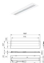
Scheda tecnica Philips Pannello A LED CoreLine RC136B 25/34W 2800-4000lm - 830 Luce Calda - | 120x30cm - UGR <19 - Dali Dimmerabile - Potenza Selezionabile - Emergenza 3H
