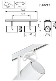
Scheda tecnica Philips Luce a Binario LED Spot GreenSpace Accent Proiettore GEN2 ST321Y Bianca 36W 3900lm 24D - 930 Luce Calda | Miglior resa cromatica
