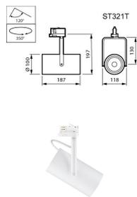
Scheda tecnica Philips Luce a Binario LED Spot GreenSpace Accent Proiettore ST321S Bianca 35W 2700lm 24D - 930 Luce Calda | Miglior resa cromatica
