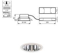
Scheda tecnica Philips Downlight LED LuxSpace Mini Profondo DN561B 9W 1350lm 75D - 840 Bianco Freddo | 164mm - Aluminium Riflettore
