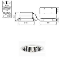
Scheda tecnica Philips Downlight LED LuxSpace Compatto Profondo DN571B 36.3W 4400lm 75D - 840 Bianco Freddo | 214mm - Aluminium Riflettore
