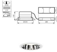
Scheda tecnica Philips Downlight LED LuxSpace Compatto Profondo DN571B 10.3W 1300lm 75D - 840 Bianco Freddo | 214mm - Aluminium Riflettore
