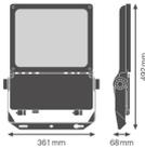
Scheda tecnica Ledvance Proiettore LED Flex Bianca 130W 19100lm 55x120D - 830 Luce Calda - | IP66 - Asimmetrico
