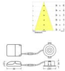
Scheda tecnica Ledvance Faretto LED Air Adjust Aluminium Bianca 4W 320lm 36D - 930 Luce Calda | Ritaglio 68mm - IP23 - Miglior resa cromatica - Dimmerabile
