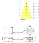
Scheda tecnica Ledvance Faretto LED Air Fix Aluminium Argento 6W 510lm 36D - 930 Luce Calda | Ritaglio 68mm - IP65 - Miglior resa cromatica - Dimmerabile
