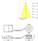
Scheda tecnica Ledvance Faretto LED Fire Rated Aluminium Bianca 8W 680lm 36D - 930 Luce Calda | Ritaglio 68mm - IP65 - Miglior resa cromatica - Dimmerabile
