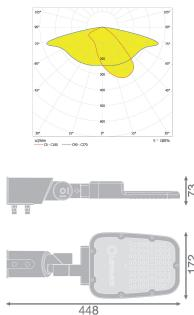
**Scheda tecnica Ledvance Proiettore LED Area Grande Grigio 45W 5850lm 160x58D - 730 Luce Calda | IP66 - Simmetrico**
