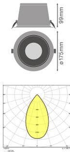
Scheda tecnica Ledvance Downlight LED Biolux HCL Zigbee Gen 2 Aluminium Bianca 20W 2100lm 60D - 927-965 Regolabile Bianca | 175mm - Ritaglio 160mm - IP20 - ZigBee
