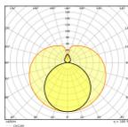
Scheda tecnica Osram Tubo LED T8 SubstiTUBE Advanced (EM/Mains) Ultra Output 16W 2250lm - 830 Luce Calda | 120cm - Sostitutiva 36W
