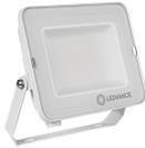
Scheda tecnica Ledvance Proiettore LED Compatto Bianca 50W 5000lm 100D - 865 Luce del Giorno | IP65 - Simmetrico
