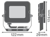
Scheda tecnica Ledvance Proiettore LED Compatto Nero 20W 1800lm 100D - 830 Luce Calda | IP65 - Simmetrico
