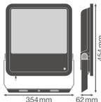
Scheda tecnica Ledvance Proiettore LED Photocell GEN 3 Nero 200W 25000lm 100D - 840 Bianco Freddo | IP65 - Sensore di luce - Simmetrico
