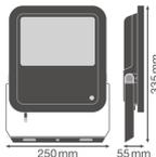
Scheda tecnica Ledvance Proiettore LED Photocell GEN 3 Nero 80W 10000lm 100D - 840 Bianco Freddo | IP65 - Sensore di luce - Simmetrico
