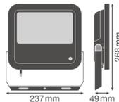
Scheda tecnica Ledvance Proiettore LED Photocell GEN 3 Nero 65W 8000lm 100D - 840 Bianco Freddo | IP65 - Sensore di luce - Simmetrico
