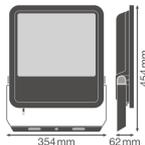
Scheda tecnica Ledvance Proiettore LED GEN 3 Nero 200W 25000lm 100D - 865 Luce del Giorno | IP65 - Simmetrico
