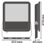
Scheda tecnica Ledvance Proiettore LED GEN 3 Nero 165W 20000lm 100D - 865 Luce del Giorno | IP65 - Simmetrico
