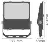
Scheda tecnica Ledvance Proiettore LED Performance Nero 150W 18400lm 55x110D - 830 Luce Calda | IP66 - Asimmetrico
